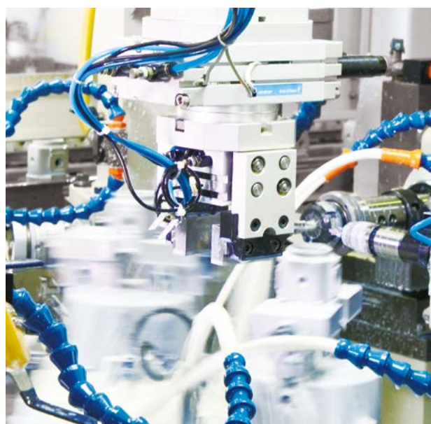
旋轉缸 (MCRQ) 與平行夾爪 (MCHX) 搭配，自動加工機應用。
