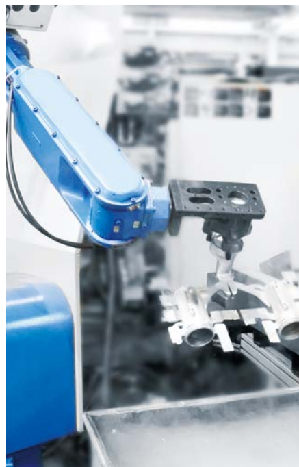
平行夾爪 (MCHJ)，壓鑄件夾取應用。
