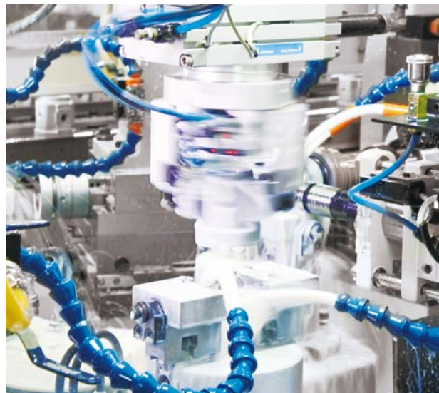
旋轉缸 (MCRQ) 與平行夾爪 (MCHX) 搭配，自動加工機應用。
